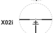
Réticule en forme de croix avec point lumineux et une échelle permettant une mesure de la distance jusqu'à un objet avec des tailles connues / échelle parallaxe/elevation (9x/12x).
