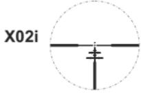
Kreuzförmiges Absehen mit dem Leuchtpunkt in der Mitte und mit der Skala, die die Entfernung bis zum Objekt mit den im voraus bekannten Abmessungen zu bestimmen ermöglicht/ die Skala erlaubt die Korrekturen vorzunehmen (9x/12x).
