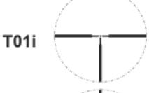
Réticule en forme de T avec point lumineux.
